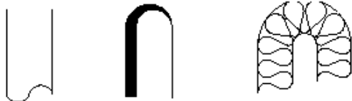
Rohr-Symbol Unterschiedliche Breiten Eine isolierte Wand
